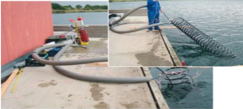
Eksperimen berkenaan dengan penyiasatan pengoptimuman pertukaran haba dalam air sekitarnya
