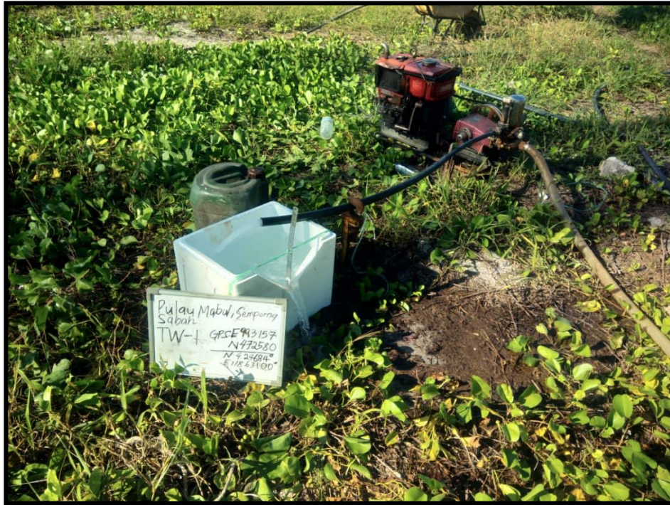
Gambar 7: Tangki V-notch 90° digunakan untuk mengukur kadar luahan air.
