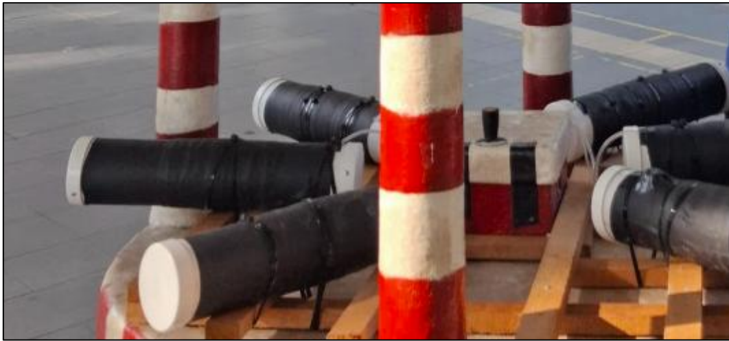
Gambarajah 2: Tiub penjana elektrik yang telah siap diapasang
