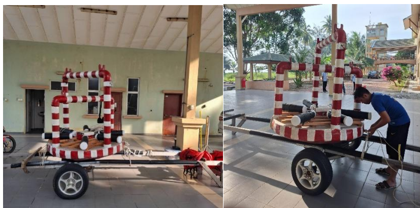
Gambarajah 14 : WEC diletakkan di kawasan yang berbumbung dan mudah diakses menjadikannya mudah untuk diselenggara termasuk kerja-kerja pembersihan
