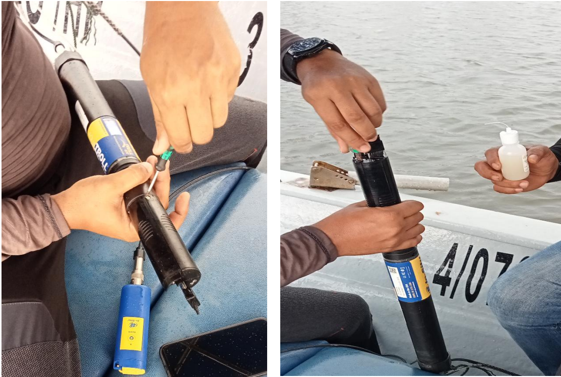
Rajah 4.12: Kerja-kerja kalibrasi alat telah dilakukan sebelum kerja-kerja menceraap data
