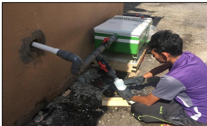
Rajah 21: Mengambil sampel air SEBELUM melalui NoFAT Versi 2
