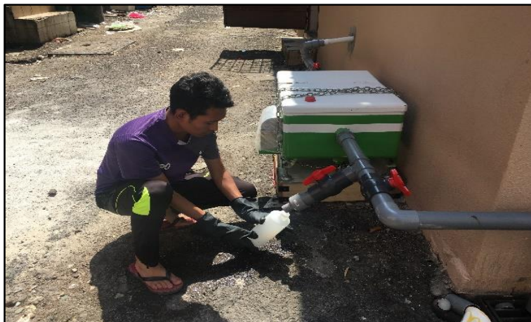
Rajah 22: Mengambil sampel air SELEPAS melalui NoFAT Versi 2
