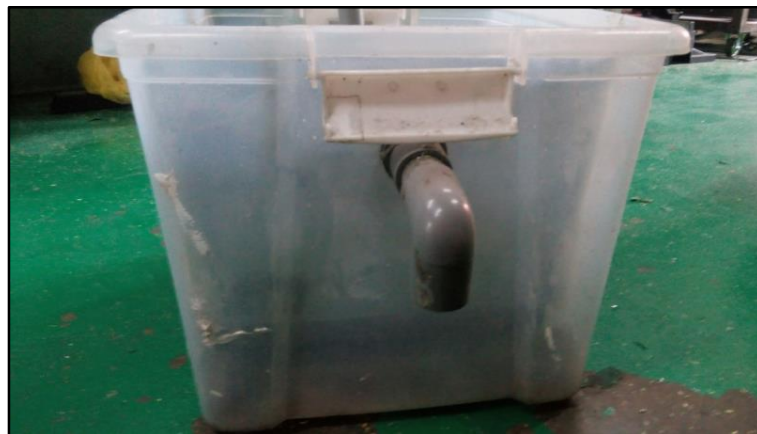
Rajah 7: Saluran air keluar dari NoFAT
