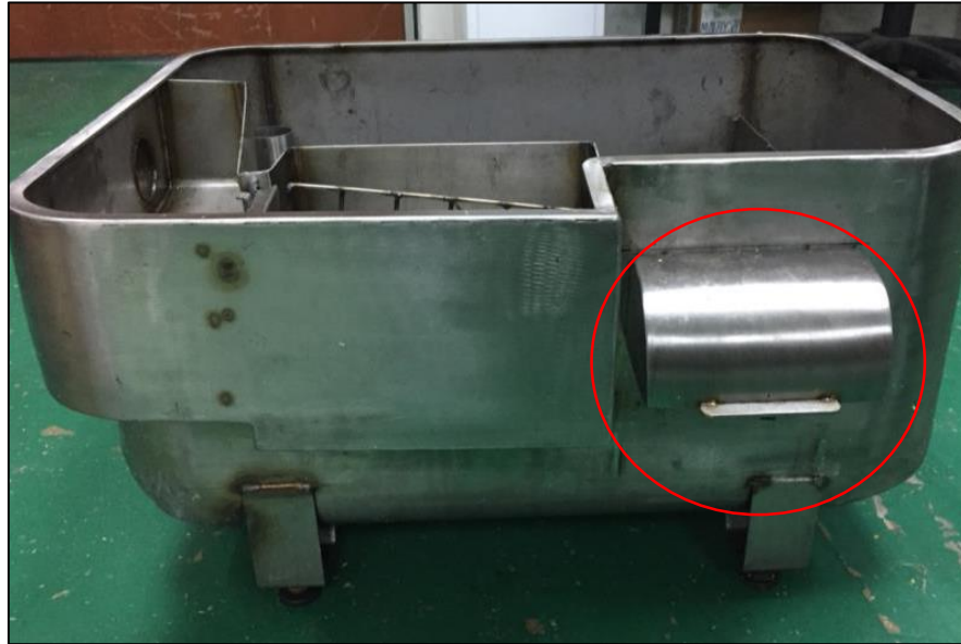
Rajah 16. Tempat pengumpulan sisa minyak
