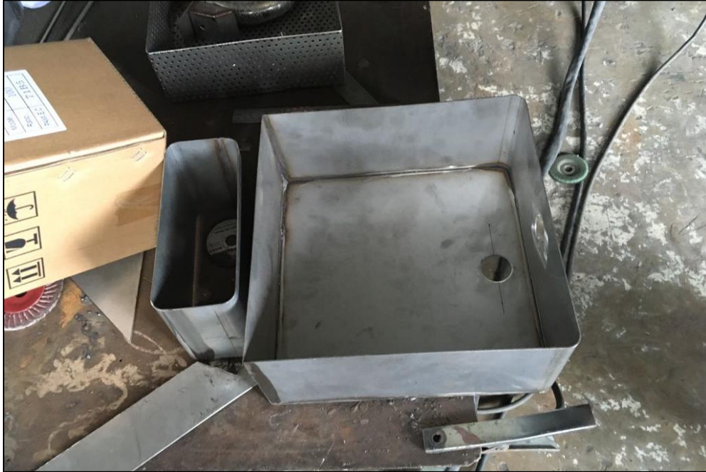
Rajah 23: Bekas pengumpulan minyak yang terperagkap dan bekas untuk ruang saluran air masuk
