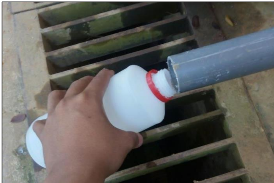
Rajah 66: Sampel air selepas mengalir keluar dari produk NoFAT diambil
