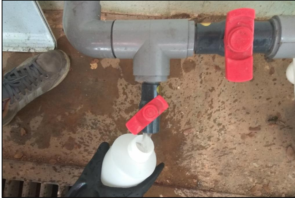
Rajah 65: Sampel air sebelum mengalir ke produk NoFAT diambil
